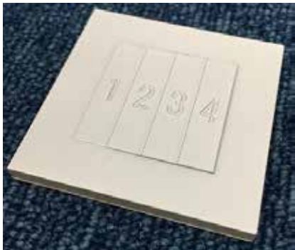
图9：被测样品。被测样品由3D打印机制作，白色，4步阶梯。每步高度为 200\mu\text{m} ，X、Y方向尺寸为 25\text{mm} \times 9\text{mm} 。
