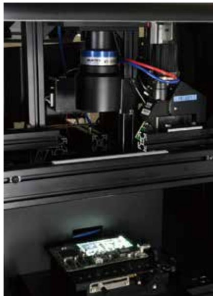
图1: 常用的三维测量方法。1-1: 激光扫描系统由线激光和面阵相机组成, 样品或激光必须移动以扫描轮廓; 1-2: 立体视觉系统, 需要两个面阵相机成不同的角度, 就像人眼一样; 1-3: 光栅投影系统包含一个光栅投影仪, 标准远心镜头及面阵相机。通常采用多投影装置, 以不同角度布置来减少投影阴影。
